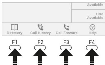
Drücken Sie auf die Taste unter dem Displaysymbol, um die symbolisierte Funktion aufzurufen, die Aktion durchzuführen etc.
